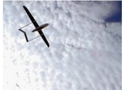
El aerosonde es una aeronave-robot que puede desarrollar misiones de varios días de duración. El aparato pesa 15 kilogramos. Aerosonde/LA NACIÓN
